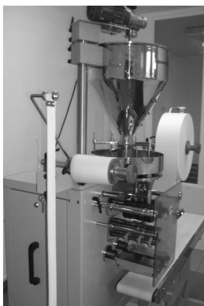
Rys. 9. Automatyczne urządzenie pakowania mieszanek ziołowych
