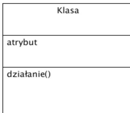
Rys. 3. Graficzna reprezentacja klasy wg specyfikacji UML
