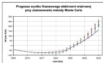
Rys. 6. Symulacja wyniku finansowego elektrowni wiatrowej przy zastosowaniu metody Monte Carlo w odniesieniu do parametrów wejściowych [9]
