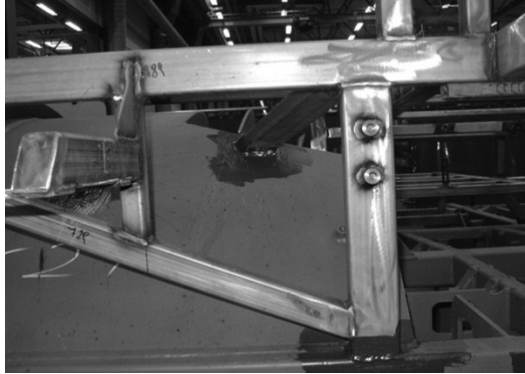
Rys. 4. Tulejki pod wspornik z zaworem odcinającym UREĘ
