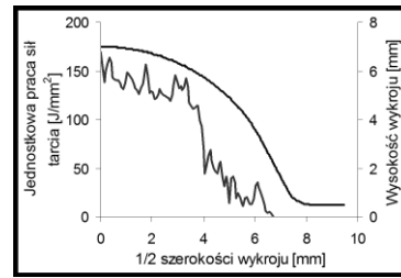
Rys. 4. Rozkład jednostkowej pracy sił tarcia na szerokości wykroju podczas procesu walcowania prętów okrągłych ze stali X2CrNi19-11 w: a) wykrojach klasycznych (wariant I), b) wykrojach modyfikowanych (wariant II)
