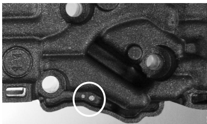
Rys. 8. Oświetlenie dwoma punktami do pomiaru wysokości obiektu
