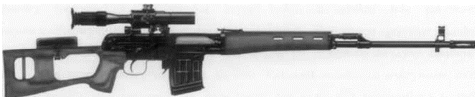
Rys.6. 7,62 mm karabin wyborowy SWD z celownikiem PSO-1
