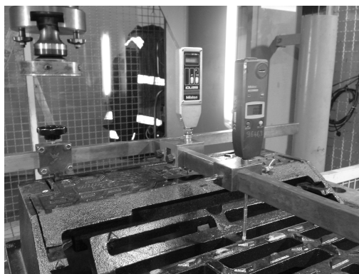
Rys. 9. Badanie strzałki ugięcia wyrobu o złożonym kształcie
