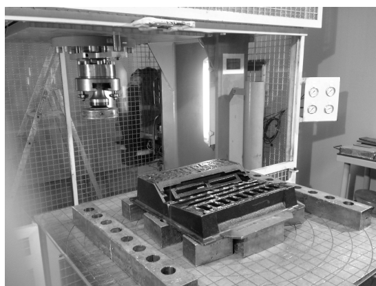
Rys. 7. Przygotowanie wyrobu do badań obciążeniowych
