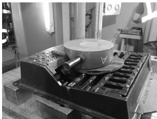
Rys. 8. Stempel do badania obciążeniowego dla wyrobu o złożonym kształcie
