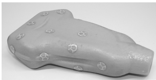
Rys. 3 Głowica wytworzona metodą 3DP z naniesionymi markerami typu "infrared"
