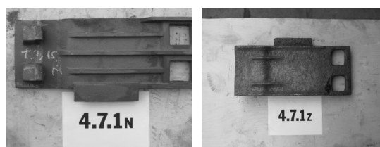
Rys.8. Stan odlewu DII (Dcementownia D, usytuowanie – środkowa część rury nurnikowej II) 4.7.1 N – odlew nowy; 4.7.1 Z – odlew po okresie eksploatacji
