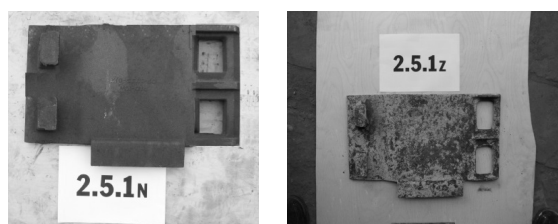
Rys.5. Stan odlewu BII (cementownia B, usytuowanie – środkowa część rury nurnikowej II. 2.5.1 N – odlew nowy; 2.5.Z – odlew po okresie eksploatacji
