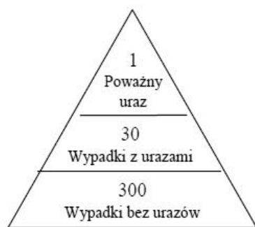
Rys. 1. Struktura wypadków na przykładzie sektora ubezpieczeniowego - Trójkąt Heinricha [2]
