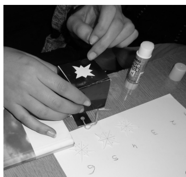
Rys. 14. Operacja 6 z polem odkładczym na komplet sześciu gwiazdek do przyklejenia na jednym wyrobie
