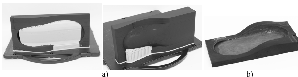
Rys. 7. a) osnowa wypełniona żywicą pozostawiona do pełnego jej utwardzenia, b) dolna połówka formy po usunięciu podpory i po wstępnym wygładzeniu powierzchni
