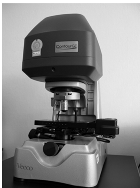
Rys. 3. Profilometr optyczny Contour GT-K1
