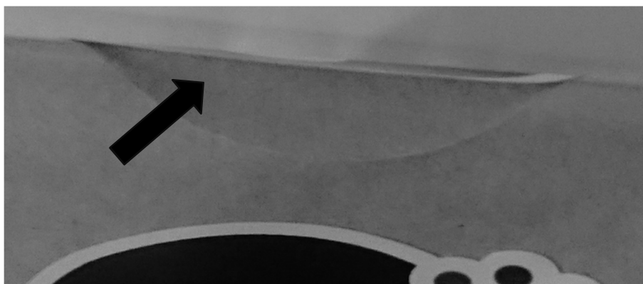
Rys. 3. Przykład podciętego podkładu wstęgi etykiet
