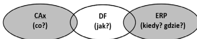
Rys. 2. Obszar zastosowania oprogramowania cyfrowej fabryki (Digital Factory) [16]
