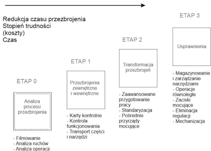
Rys. 1. Cztery kroki implementacji metody SMED Źródło: opracowanie własne na podstawie [19]
