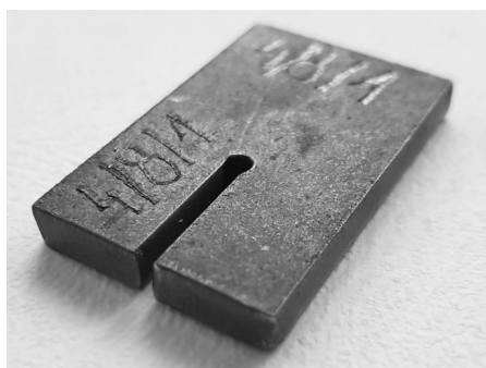
Rys. 1. Przykładowa próbka 40 x 25 mm Źródło: opracowanie własne
