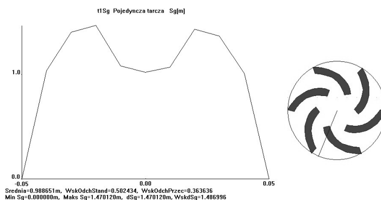
Rys. 3. Konstrukcja tarczy ścierniej z 6 wyoblonymi segmentami diamentowymi o wymiarach 8x36mm rozmieszczonych po obwodzie tarczy R-R 1 (R=50mm i R 1 =32.5mm) z wykresem rozkładu skuteczności oddziaływania segmentów diamentowych określonej na osi pionowej, przy jednym przejściu tarczy po linii sensorów rozmieszczonej na osi poziomej, odpowiadającej średnicy tarczy.
