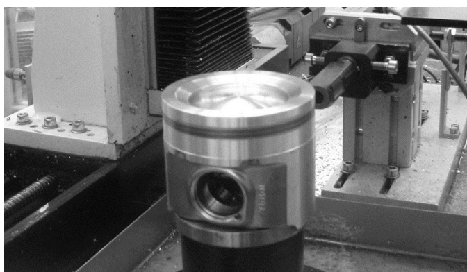
Rys. 2. Przedmiot badań – tłok silnika wysokoprężnego stosowanego w samochodach osobowych
