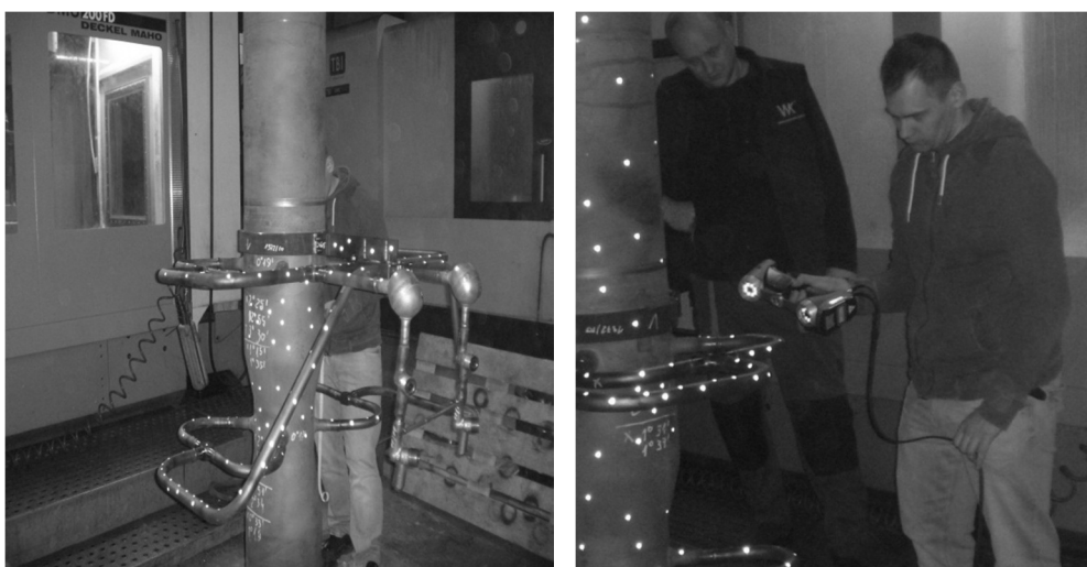
Rys. 1. Proces nakładania markerów na badane urządzenie i skanowanie
