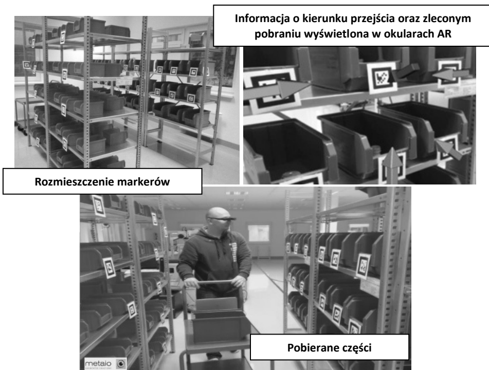
Rys. 7. Pobieranie części z wykorzystaniem systemu rozszerzonej rzeczywistości Źródło: [5]
